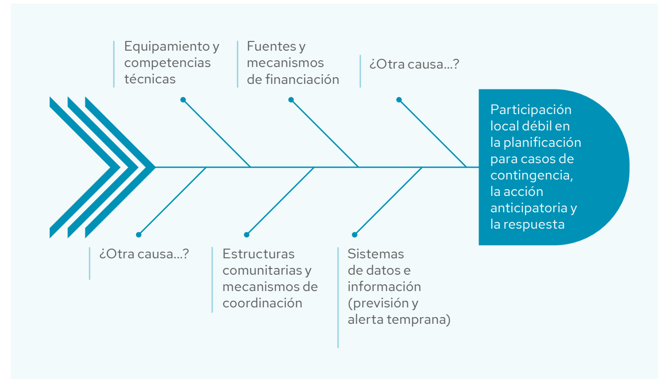
Arriba: El análisis de espina de pescado ayuda a categorizar las causas y a identificar las cuestiones centrales que, de abordarse, resolverían el problema principal. Intente terminar con no más de seis categorías generales.
